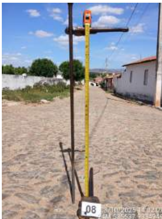
Foto 08 – Solo argiloso sobre rocha em ST 08. Rua Manoel Nunes de Sousa/Rua Manoel Costa Moraes, com revestimento em pedra tosca.
