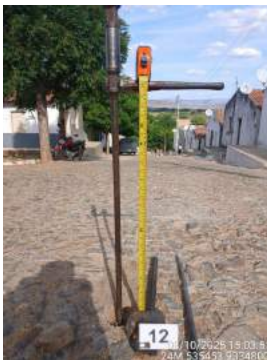
Foto 12 – Solo argiloso sobre rocha em ST 12.
