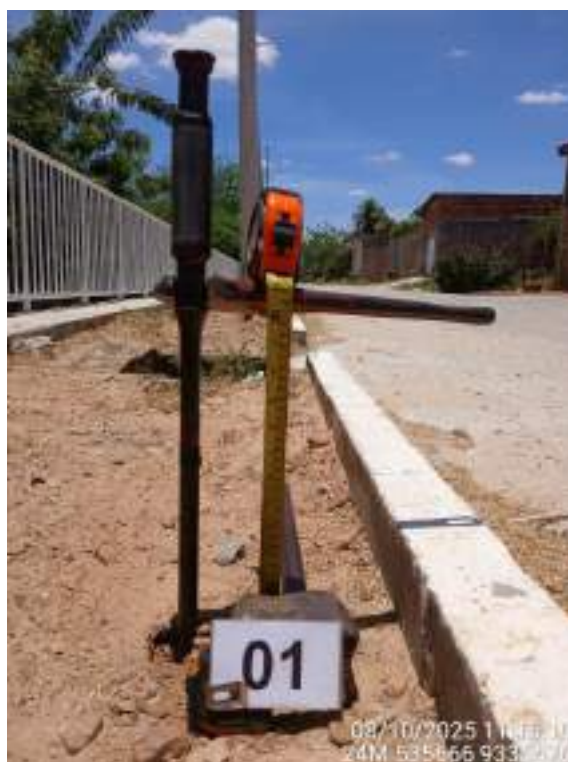
Foto 01 – Material de aterro compactado na base em ST 01. Av. Maria Marta – Revestimento piso intertravado.
