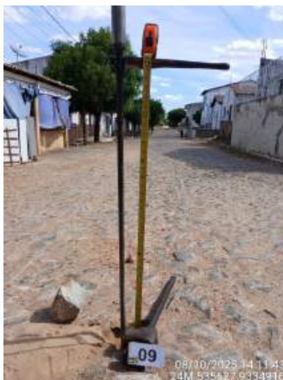
Foto 09 – Solo argiloso sobre rocha em ST 09.
