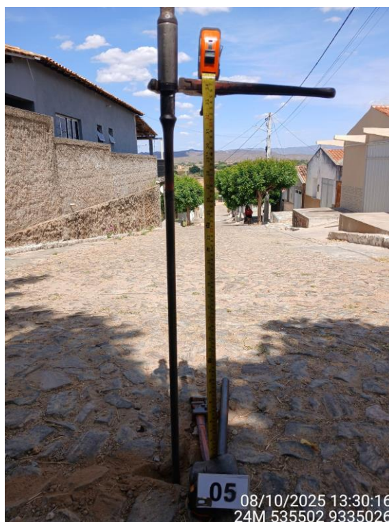
Foto 05 – Solo residual argiloso sobre rocha em ST 05. Rua São Vicente de Paula - Revestimento em pedra tosca.
