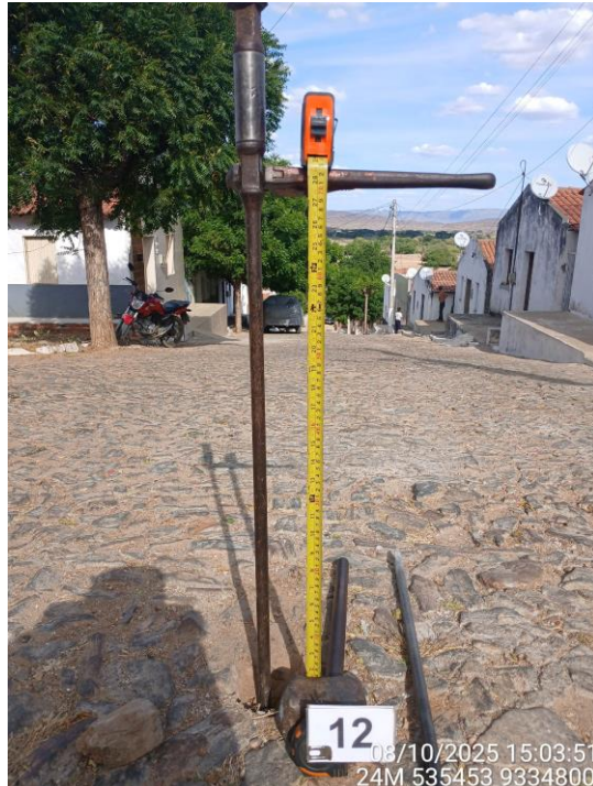
Foto 12 – Solo argiloso sobre rocha em ST 12.
