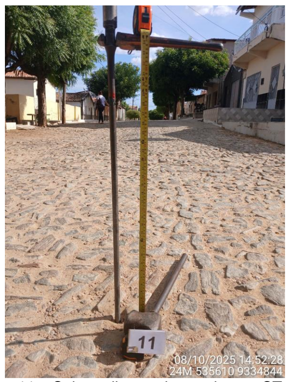
Foto 11 – Solo argiloso sobre rocha em ST 11. Rua Cel. Vígílio N. da Paz/R. José Simão de Oliveira, com revestimento em pedra tosca.
