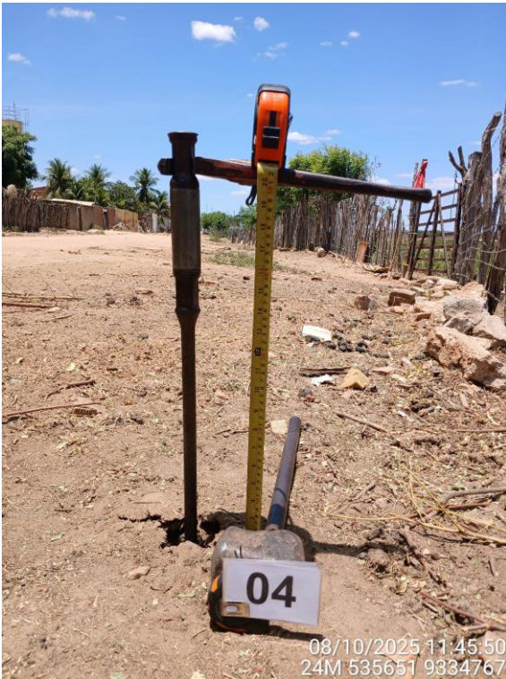
Foto 04 – Solo aluvionar argiloso compactado na base em ST 04. Rua Maria Marta em terreno natural.
