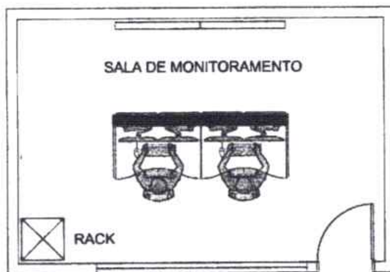
Figura 01– Layout Sala de Operação e Monitoramento
