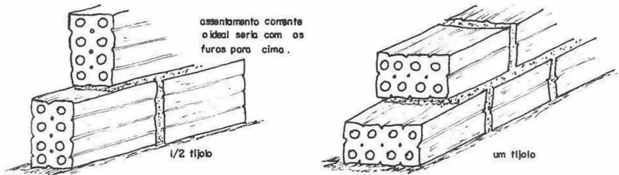
Figura 1 - Execução de alvenaria utilizando tijolos furados.
