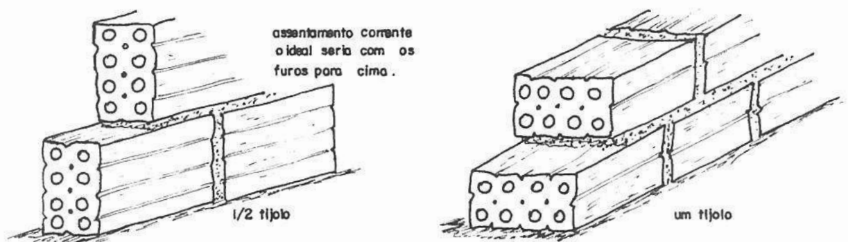
Figura 1 - Execução de alvenaria utilizando tijolos furados.
