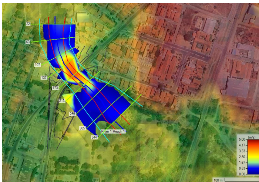
Figura 13. Mancha de inundação – Perfil de velocidade (HEC-RAS)
